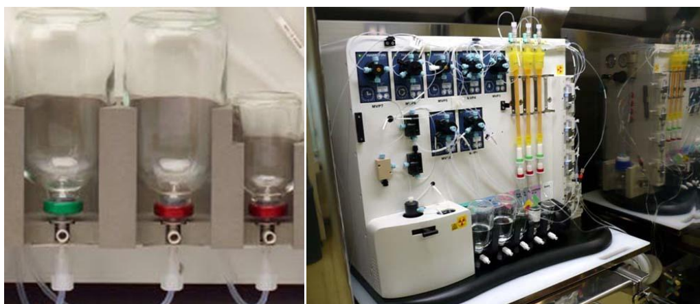
Figure 2.13: Automated Explora Radiochemistry module with manual column (d) courtesy Siemens Ltd.
