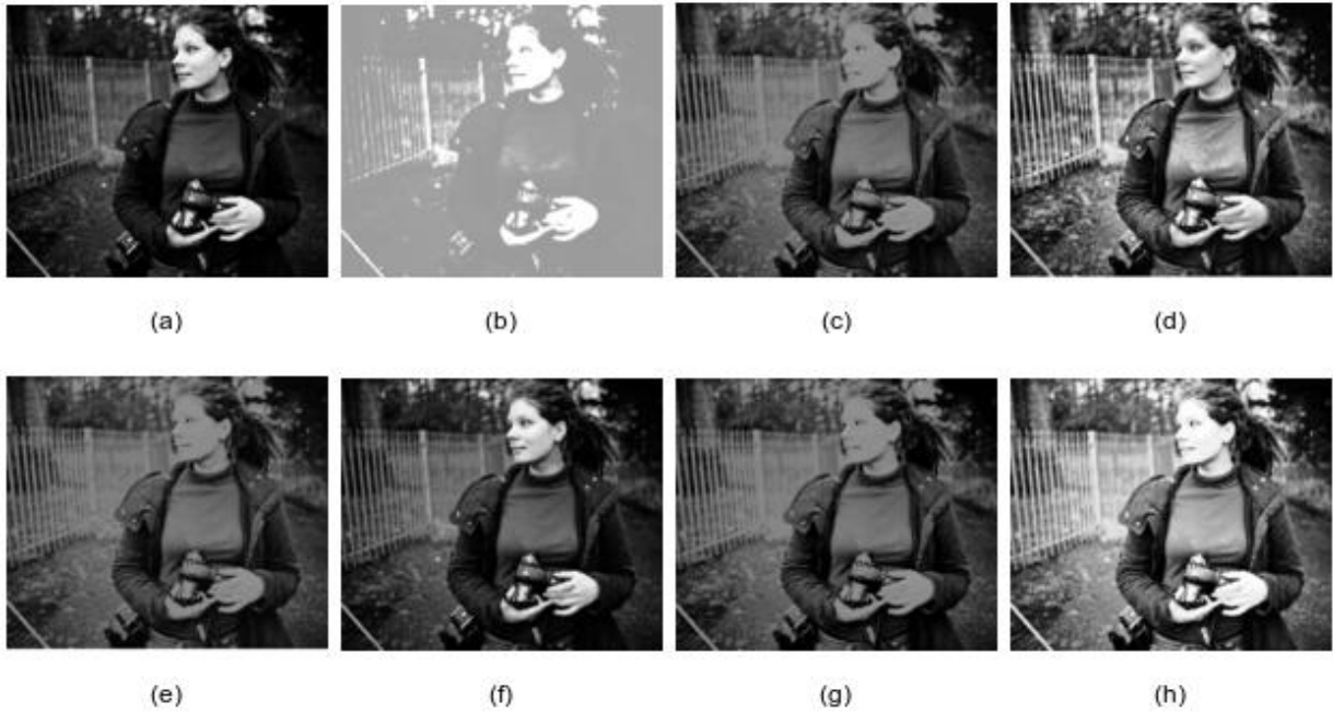
FIGURE 3.6 : (a) ORIGINAL IMAGE- 2, (b) CT, (c) HE, (d) CLAHE, (e) BBHE, (f) DSIHE, (g) MMBEBHE, (h) BPDHE
