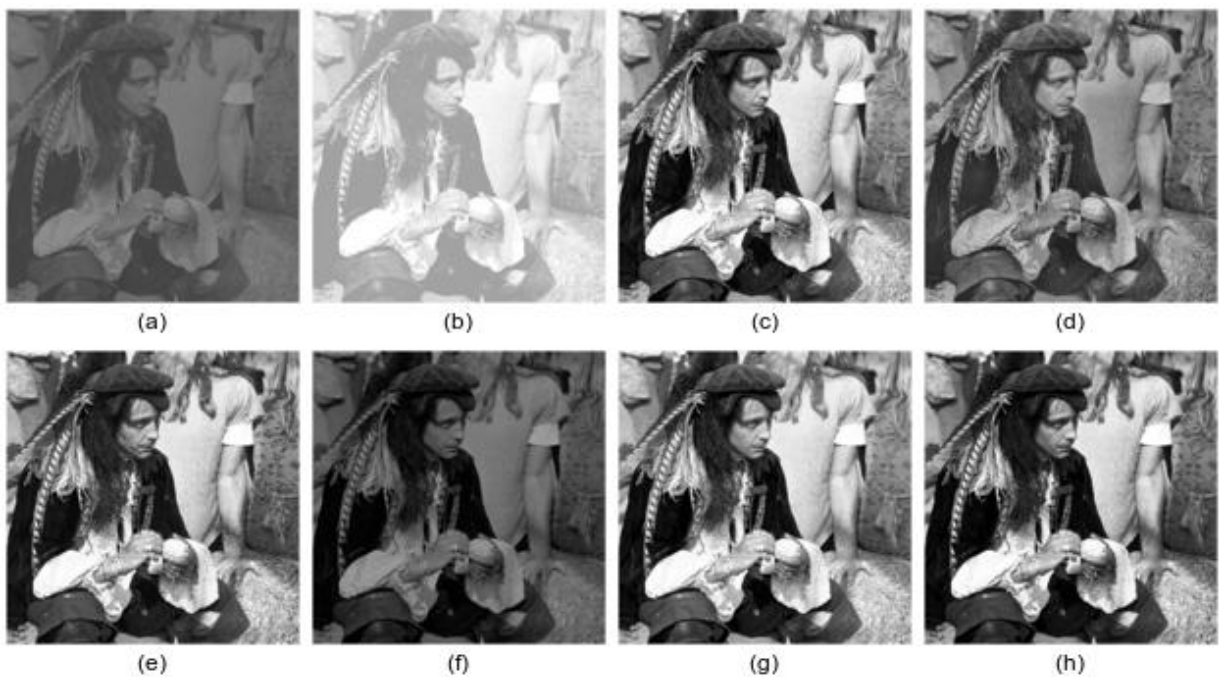
FIGURE 3.5 : (a) ORIGINAL IMAGE-1, (b) CT, (c) HE, (d) CLAHE, (e) BBHE, (f) DSIHE, (g) MMBEBHE, (h) BPDHE
